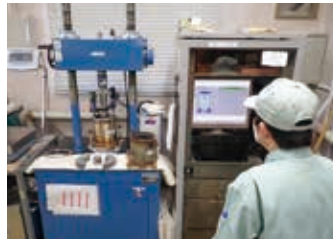
修正CBR試験
