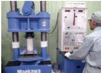
コンクリートの圧縮強度試験
