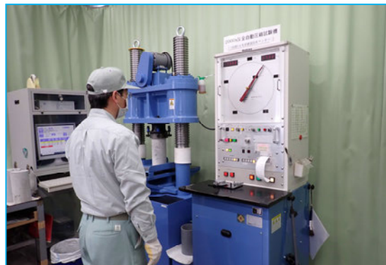
コンクリート圧縮試験
