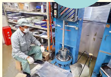
突固めによる土の締固め試験
