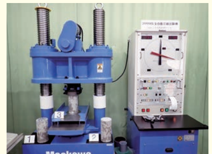
コンクリート圧縮強度試験
